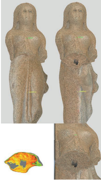
Figure 9. Contrôle d'accostage. Modèle 3D de la statue d'Isis du phare d'Alexandrie aimablement communiqué par Isabelle Hairy, Architecte-archéologue au CRES (Mondes Pharaoniques), CNRS, UMR8167 (Orient & Méditerranée). En haut à gauche, relief normal. En haut à droite, le modèle des jambes est inversé : la mortaise d'assemblage apparaît. En bas, cartographie hypsométrie temps réel de la surface de contact : rouge = pénétration, noir = contact, vert = séparation.
