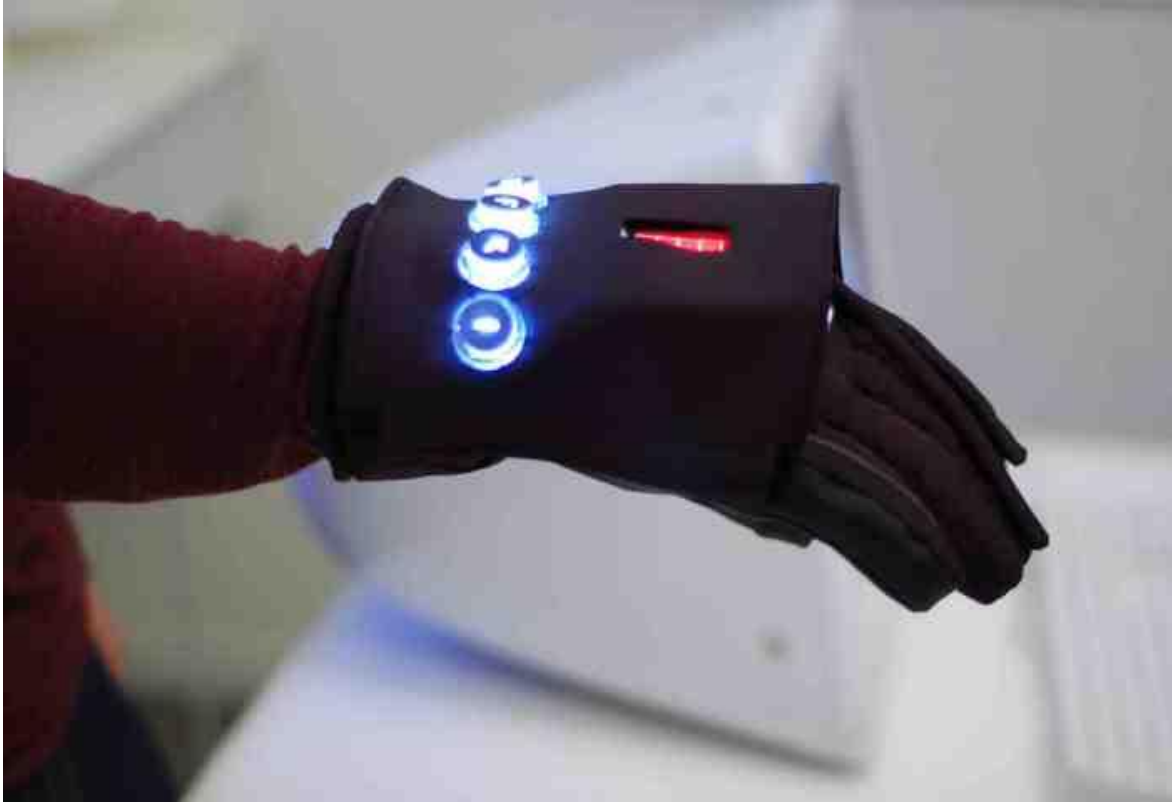
Fig. 3 : Frontline, gants connectés pour pompiers.
