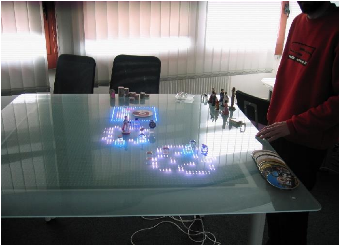
Figure 4 : la table Tangisense ici dans une configuration de création musicale. Des zones lumineuses (leds dans la table) sont activées par des « personnages » tangibles. Un cube en premier plan représente un instrument de musique, un CD en deuxième plan représente une base de données de sons que l'on peut « déverser » sur la table. La table se présente comme une matrice carrée de « pixels » magnétiques (40 x 40).
