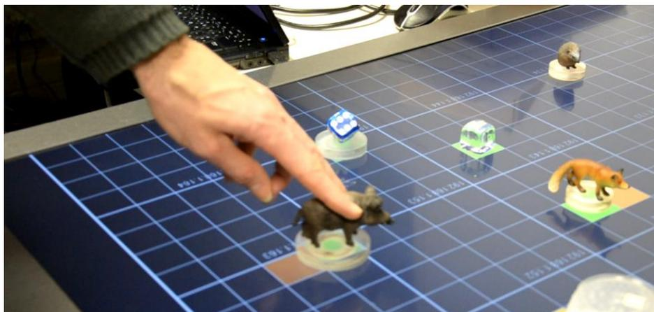
Tangisense supporte tous les badges RFID ISO15693 du marché d'une taille au choix de l'utilisateur, et supporte le protocole de collision, c'est à dire la présence de badges multiples simultanément sur une même antenne.
