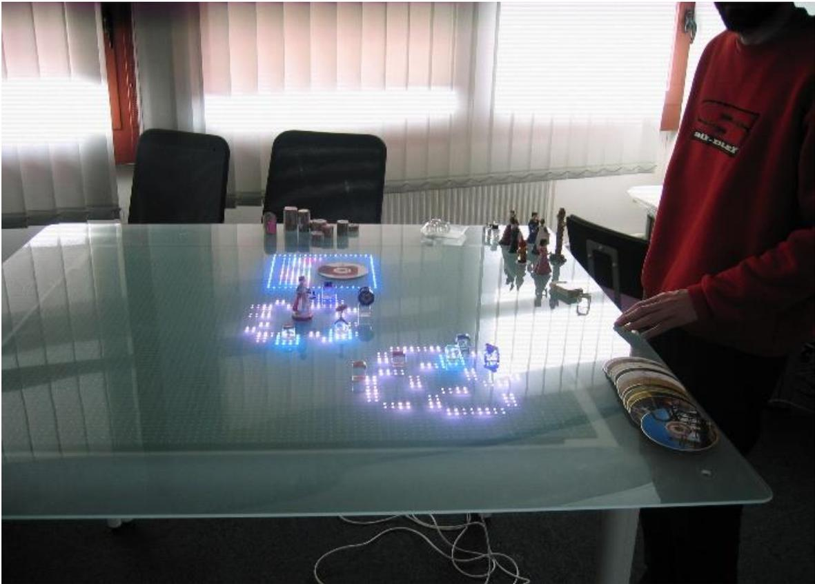
Figure 4 : la table Tangisense ici dans une configuration de création musicale. Des zones lumineuses (leds dans la table) sont activées par des « personnages » tangibles. Un cube en premier plan représente un instrument de musique, un CD en deuxième plan représente une base de données de sons que l'on peut « déverser » sur la table. La table se présente comme une matrice carrée de « pixels » magnétiques (40 x 40).
