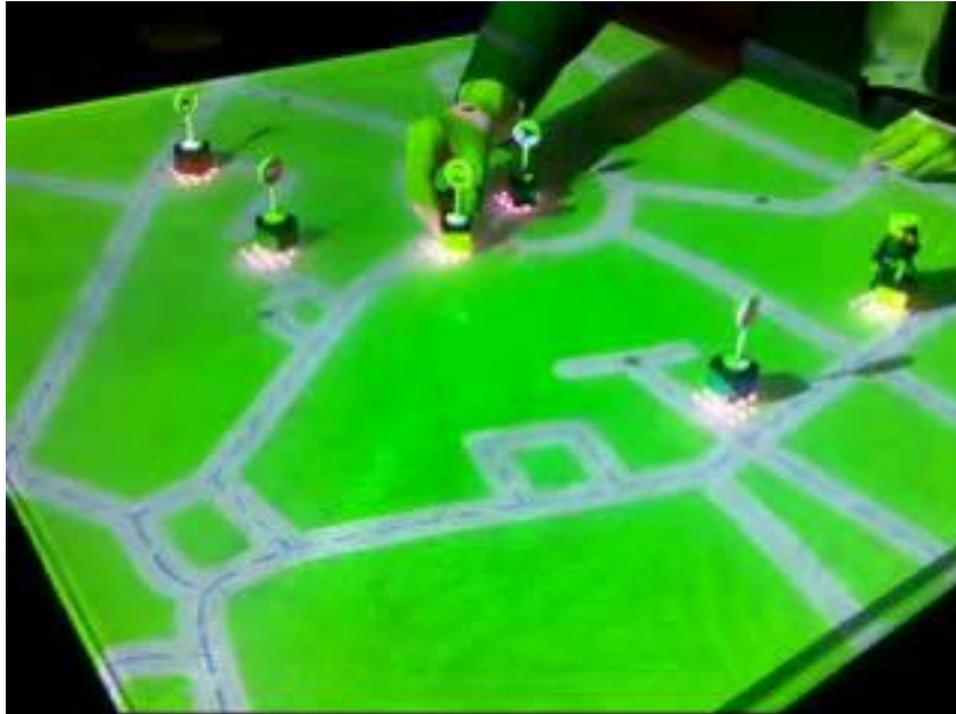
Figure 5 : la table TangiSense utilisée dans une application de simulation de trafic routier. On y distingue les objets tangibles (panneaux routiers par exemple) et les objets virtuels vidéo-projetés (routes par exemple).
