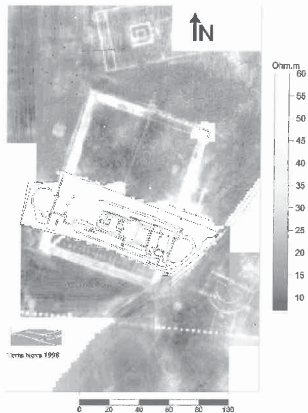
Fig. 1 Prospection électrique : détection et cartographie de structures archéologiques enfouies.
