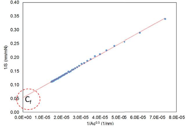
**Fig. 2.** Complaisance total mesurée à partir de l'inverse de la pente à la décharge en fonction de l'inverse de la racine carré de l'aire de contact supposée connue. L'interception de cette droite avec l'axe des ordonnées correspond à la valeur de la complaisance de la machine  $C_f$ .
