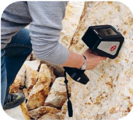
Figure 3. Analyse de pegmatite sur un front de taille pour la quantification du lithium.
