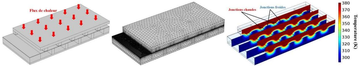
**Figure 4.** Structure de simulation d'un demi-  $\mu$ TEG à 5 membranes et distribution de la température (COMSOL 3D®)
