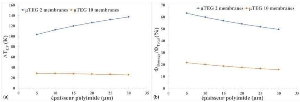
**Figure 5.** (a) Gradients de température  $\Delta T_{CF}$  et (b) Pourcentage de flux perdu dans les bossages en fonction de l'épaisseur de polyimide
