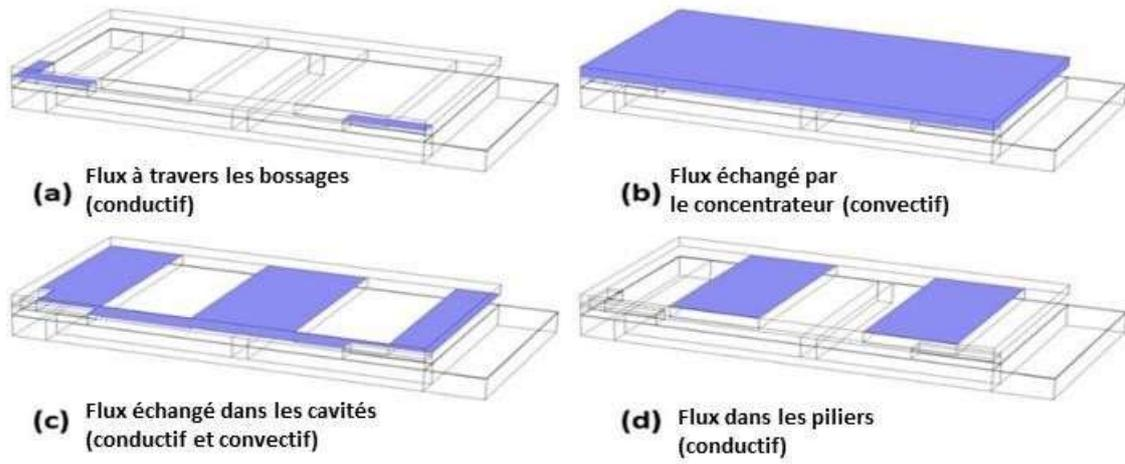
**Figure 3.** Principaux flux thermiques traversant un  $\mu$ TEG à 2 membranes.
