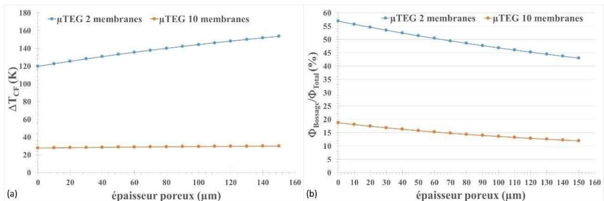
**Figure 8.** Gradients de température  $\Delta T_{CF}$  et Flux perdu à travers les bossages porosifiés ( $\mu\text{TEG}$  à 2 et 10 membranes et densité surfacique de flux thermique incident de  $4\text{W}/\text{cm}^2$ )
