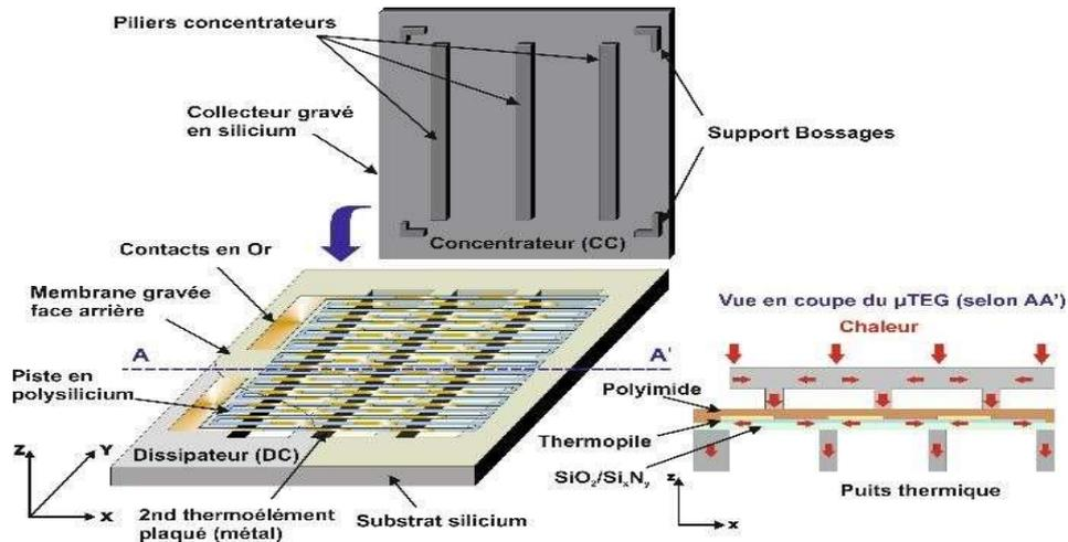
**Figure 1.** Structure d'un  $\mu$ TEG à 3 membranes (vue « éclatée » et vue en coupe)
