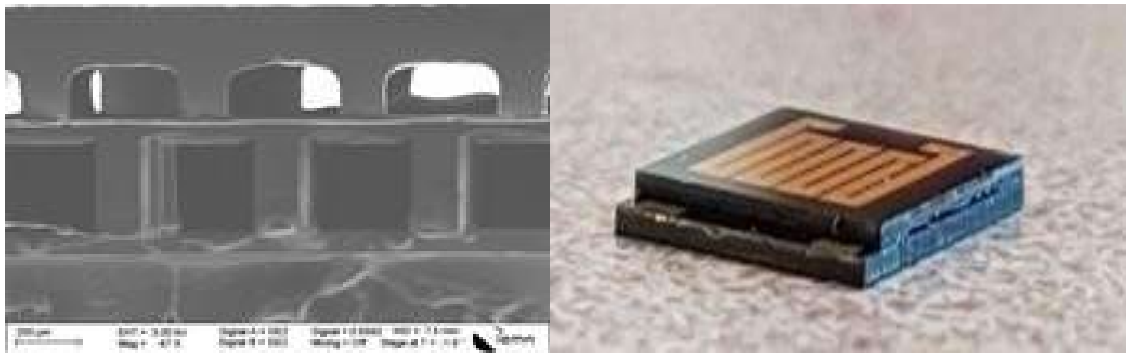
Figure 2. Vue en coupe au microscope électronique et photographie d'un \mu TEG monolithe
