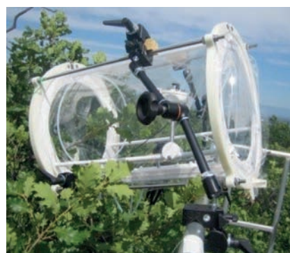
Figure 1. Chambre dynamique en téflon enfermant une branche de chêne blanc au sommet de la canopée.
