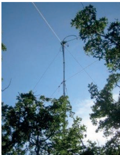
Figure 2. Mât de 10 mètres sur lequel sont fixées les lignes de prélèvement de l'air, ainsi que l'anémomètre sonique pour la mesure du vent.
