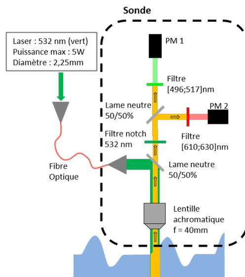
**Figure 2.** Montage optique pour la technique 2c-LIF
