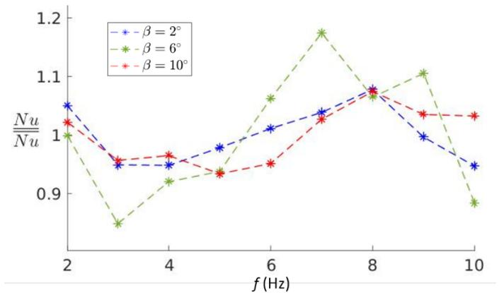
**Figure 8.** Effets de la fréquence des vagues sur les transferts de chaleur entre le film et le solide pour  $x = 270 \text{ mm}$ ,  $Re = 200$  et  $q_w = 1,25 \text{ W/cm}^2$
