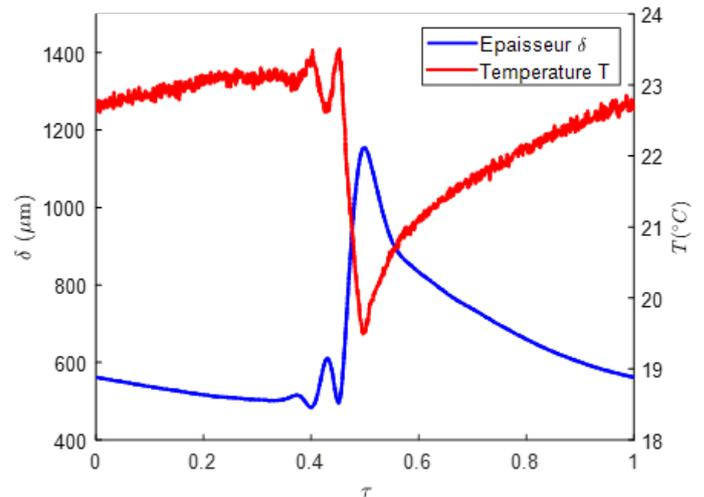
**Figure 6.** Mesures d'épaisseur et température LIF instantanées d'un film perturbé à une fréquence  $f = 5$  Hz à  $x = 270$  mm pour  $Re = 200$ ,  $\beta = 10^\circ$  et  $q_w = 1,25$  W/cm<sup>2</sup>
