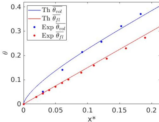
**Figure 5.** Comparaison de l'évolution spatiale des températures adimensionnées entre théorie (lignes) et expériences (points) pour  $Re = 200$ ,  $\beta = 10^\circ$  et  $q_w = 1,25$  W/cm<sup>2</sup>
