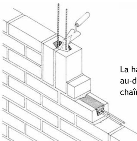
Les fers sont bloqués par du béton coulé dans des blocs « U » disposés verticalement.
