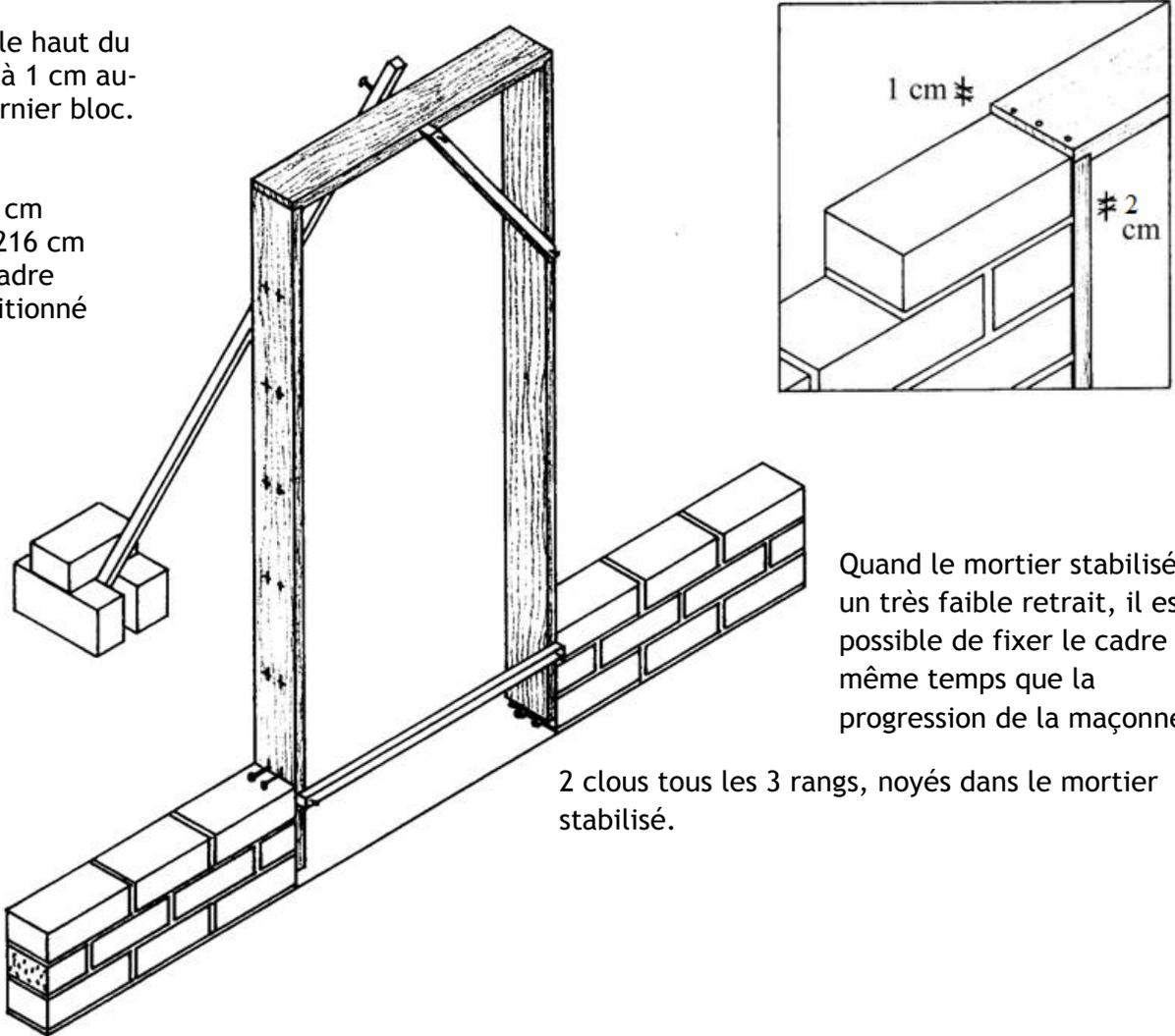
Quand le mortier stabilisé a un très faible retrait, il est possible de fixer le cadre en même temps que la progression de la maçonnerie :
