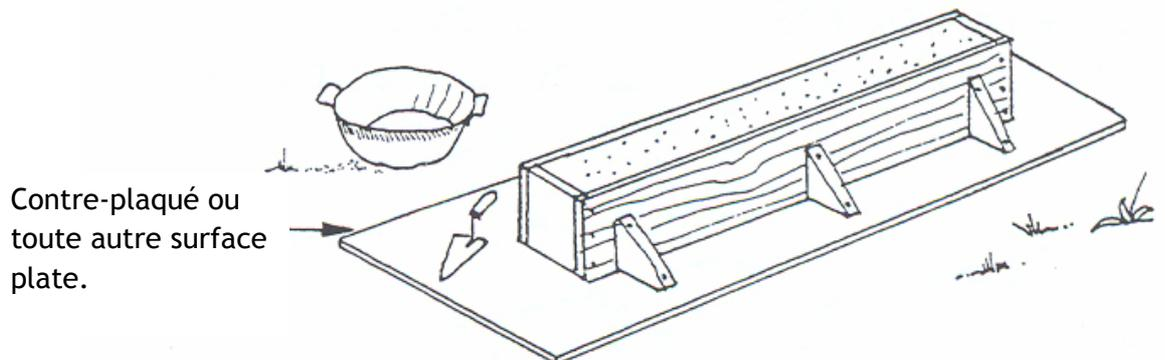
Les barres de renforcement doivent être placées toujours en bas du linteau. Donc pour les linteaux préfabriqués, il faut toujours marquer le dessus pour ne pas se tromper lors de la mise en place.
