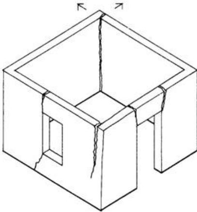
Les mouvements du terrain ou la poussée d'une toiture peuvent déchirer les murs au niveau des angles.
