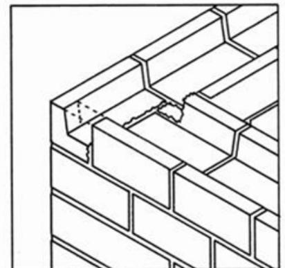
**Châinage en béton armé.**
