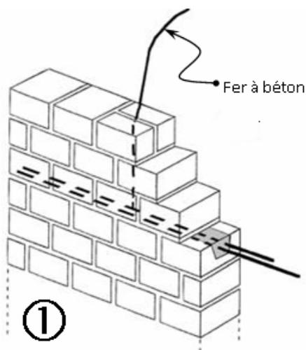
Le fer d'accroche passe verticalement entre les blocs car ils sont carrés.
