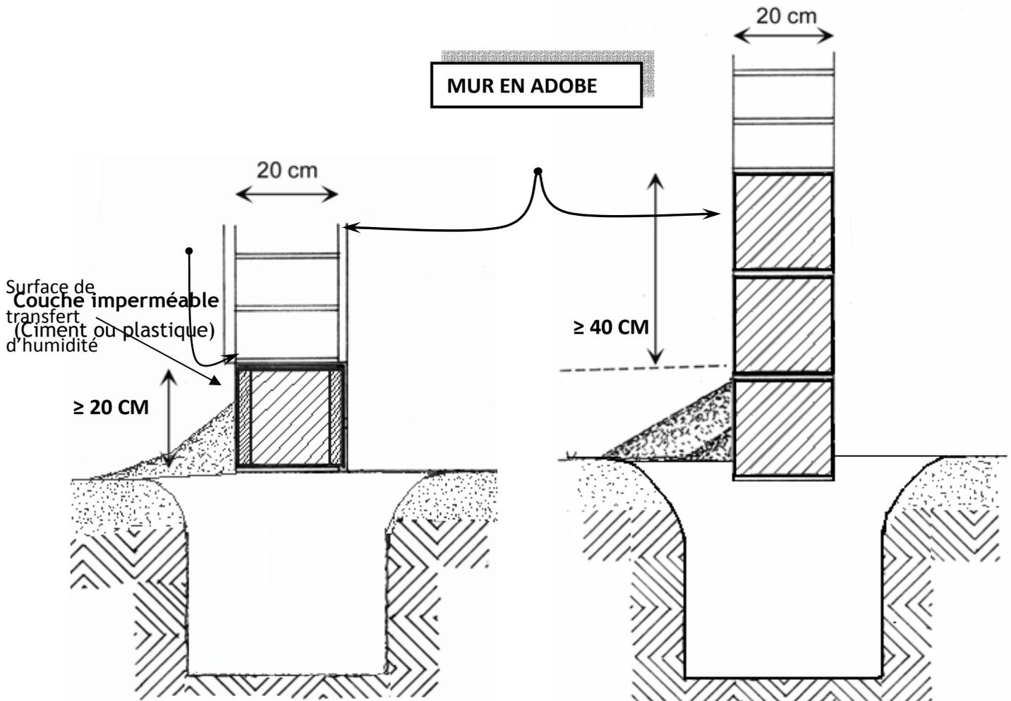
La barrière anti-capillaire stoppe les remontées d'humidité dans le mur. La hauteur du soubassement peut être réduite.
