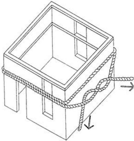
Le chaînage permet de maintenir les murs, de les « *liaisonner* » entre eux.
