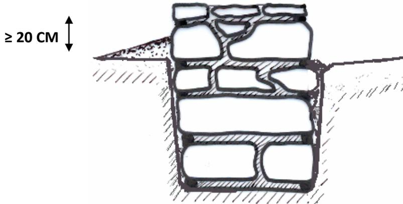
Il est aussi possible de réaliser le soubassement avec des blocs stabilisés.
