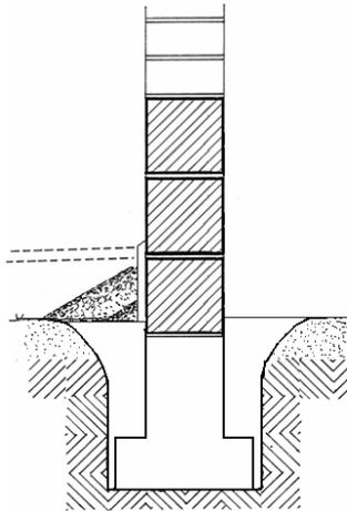
La hauteur de soubassement est définie par la hauteur maximale des possibles remontés capillaire (celles-ci étant en particulier en relation avec les caractéristiques des matériaux utilisés pour réaliser le soubassement)
