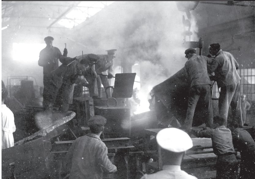
Taller de Fundición: proceso de confección de un ancla, 6 de noviembre de 1943 . MNPB
