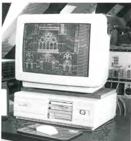
Restituteur Wild BC3. Le fichier numérique est affiché en temps réel sur le moniteur, sous forme graphique.
