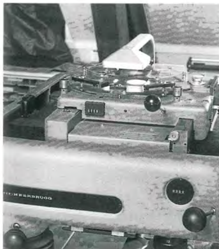
Restituteur Wild Aviomap AMU. Le calculateur assure principalement la transmission à une table traçante. Les angles de rotation des clichés l'un par rapport à l'autre et dans l'espace sont introduits réellement par l'intermédiaire de compteurs.
