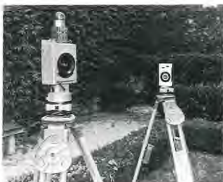
Chambre simple Zeiss TMK.
