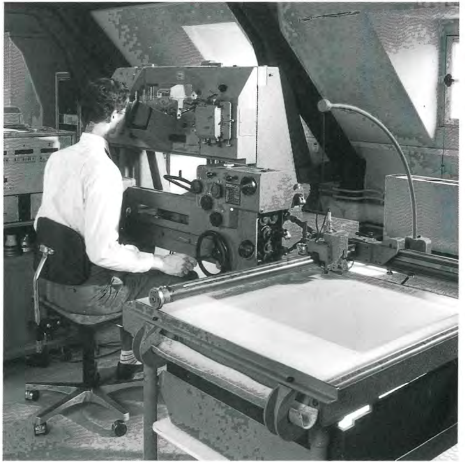
Restituteur Wild A40. La mécanique reproduit le phénomène purement optique de l'intersection dans l'espace des rayons qui se trouvent matérialisés par les deux tiges au premier plan. Des engrenages assurent la transmission des mesures à la table à dessin.
