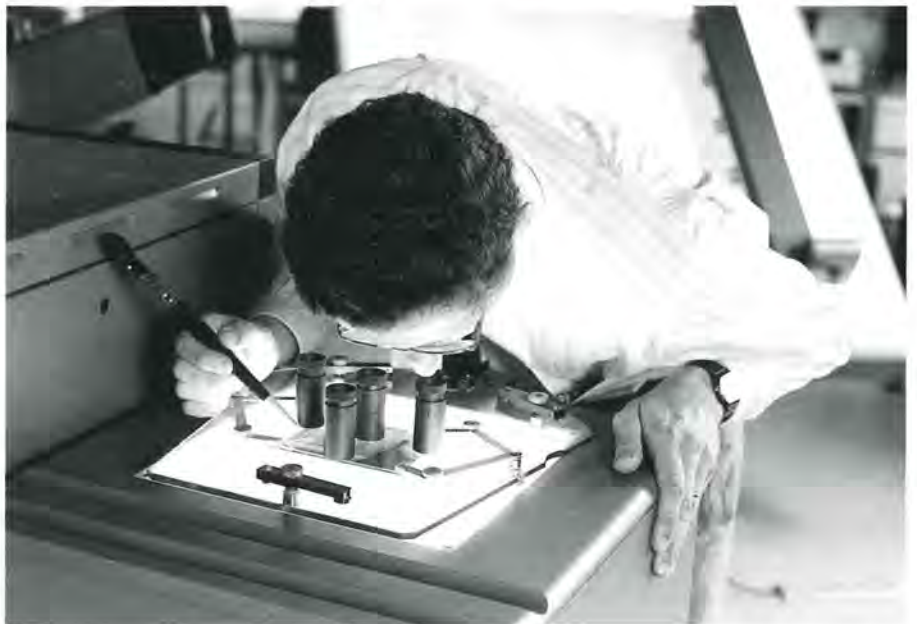
Le centrage des clichés sur les appareils analogiques Wild A40 (1) et Wild Aviomap AMU (3) et leur disposition sur l'appareil analytique Wild BC3 (2).
