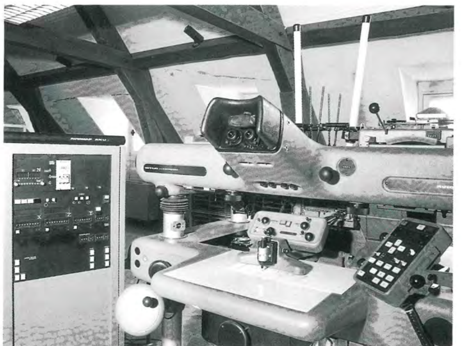
Restituteur Wild Aviomap AMU. Le calculateur assure principalement la transmission à une table traçante. Les angles de rotation des clichés l'un par rapport à l'autre et dans l'espace sont introduits réellement par l'intermédiaire de compteurs.
