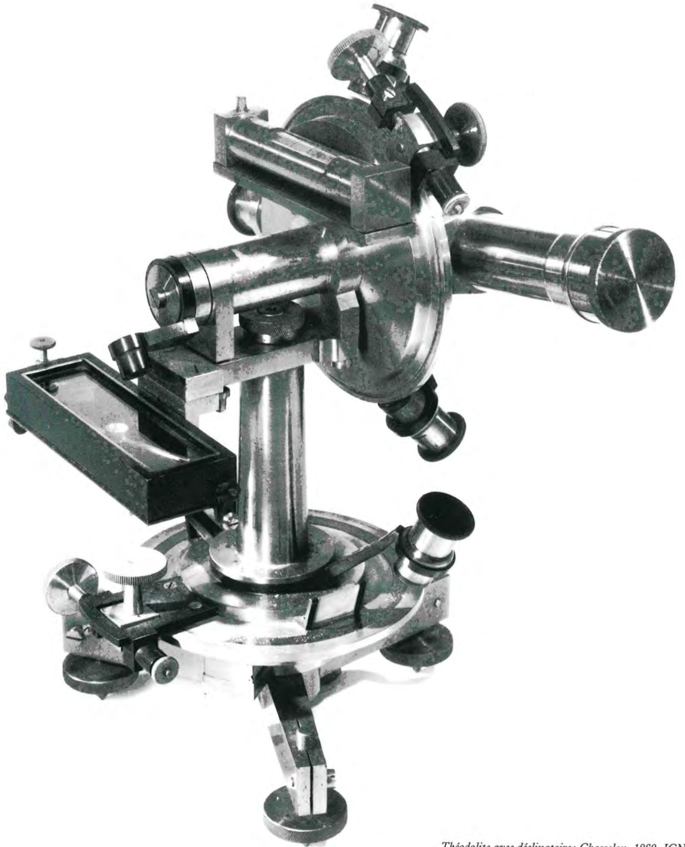
Théodolite avec déclinaire; Chasselon, 1860. IGN.
