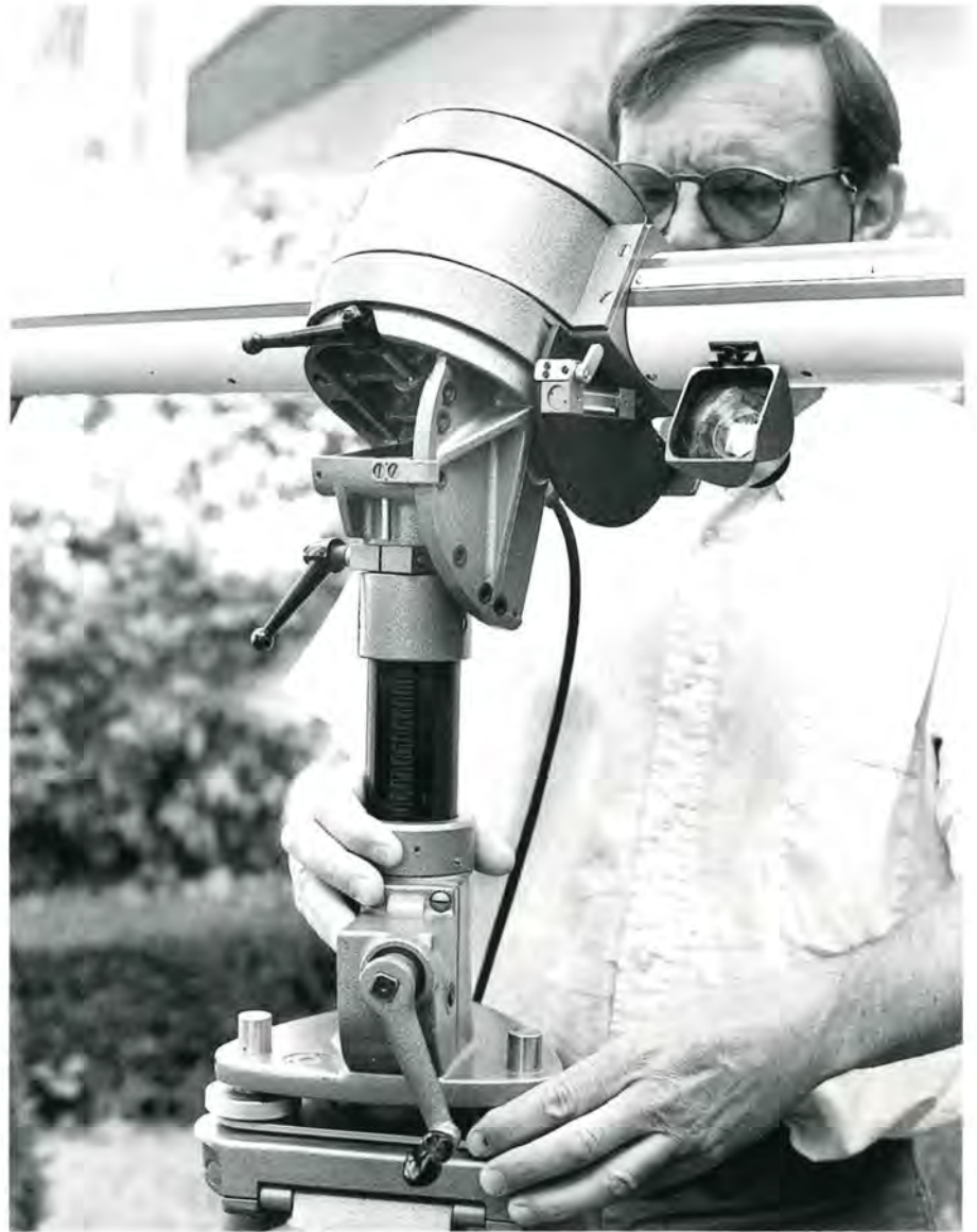
Manipulation des vis calantes pour le calage des nivelles croisées d'une chambre double Wild C120.
