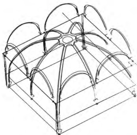
Noyon (60), cathédrale Notre-Dame, voûte de la croisée du transept, isométrie obtenue par photogrammétrie à partir du fichier de plan.
