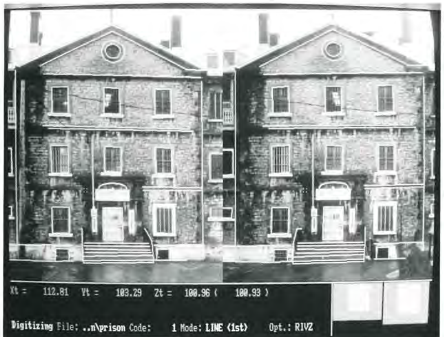
Le DVP de Leica permet de renvoyer en superposition à la photographie, l'analyse dessinée introduite dans un mode perspectif.
