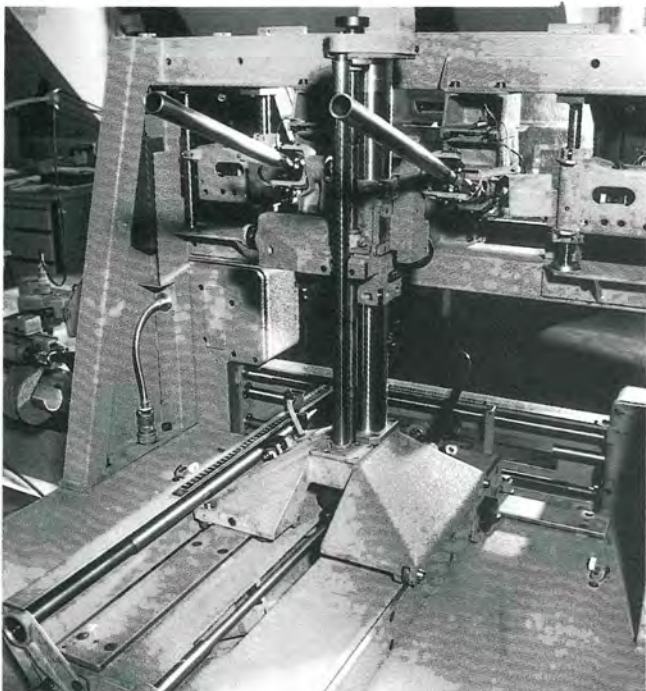
Restituteur Wild A40. La mécanique reproduit le phénomène purement optique de l'intersection dans l'espace des rayons qui se trouvent matérialisés par les deux tiges au premier plan. Des engrenages assurent la transmission des mesures à la table à dessin.
