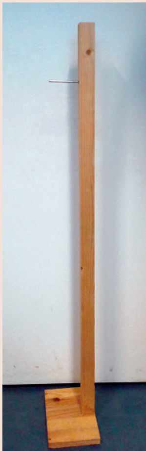
Figure 1. Support du balancier avec la tige de métal.
