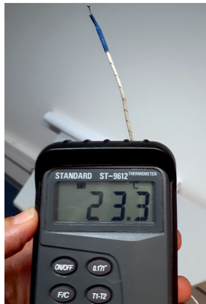
Figure 3. Exemple de mesure de la température de l'air avec un thermomètre à thermocouple.
