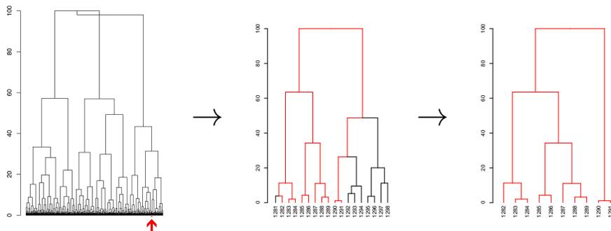
FIGURE 2 – Gauche : Dendrogramme  $\mathbf{D}^t$ . En rouge est indiquée la zone correspondant à l'intervalle  $I_l$  considéré. Centre : Plus petit sous-arbre induit par  $\mathbf{D}^t$  recouvrant  $I_l$ . En rouge sont indiquées les branches correspondant à des feuilles dans  $I_l$ . Droite : Sous-arbre  $D_l^t$  obtenu après élagage des feuilles extérieures à  $I_l$ .
