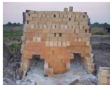
Four de production artisanale de briques cuites. Kabalo, Tanganyika. © O. Moles - CRAterre
