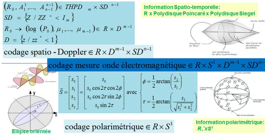
Figure 2 : Codage de la mesure spatio-Doppler et polarimétrique dans l'espace métrique  $\mathfrak{R} \times S^1 \times D^{m-1} \times SD^{n-1}$
