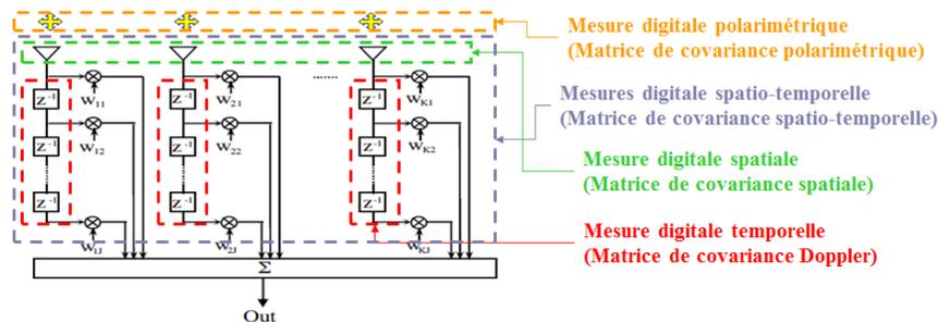
Figure 1 : illustration d'antenne tout numérique :
