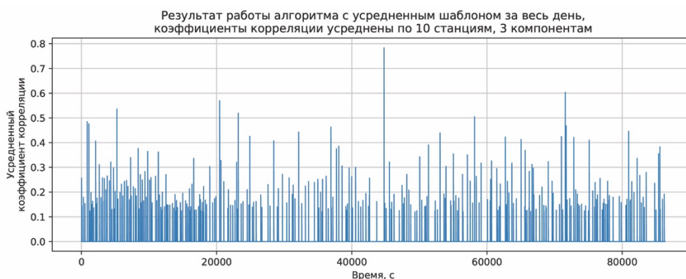
Рис. 6. Результат детектирования с усреднённым шаблоном по всем станциям и компонентам CC_{\text{среднее}} < CC_{\text{пороговое}} (в данном случае пороговое значение коэффициента корреляции 0.12)
