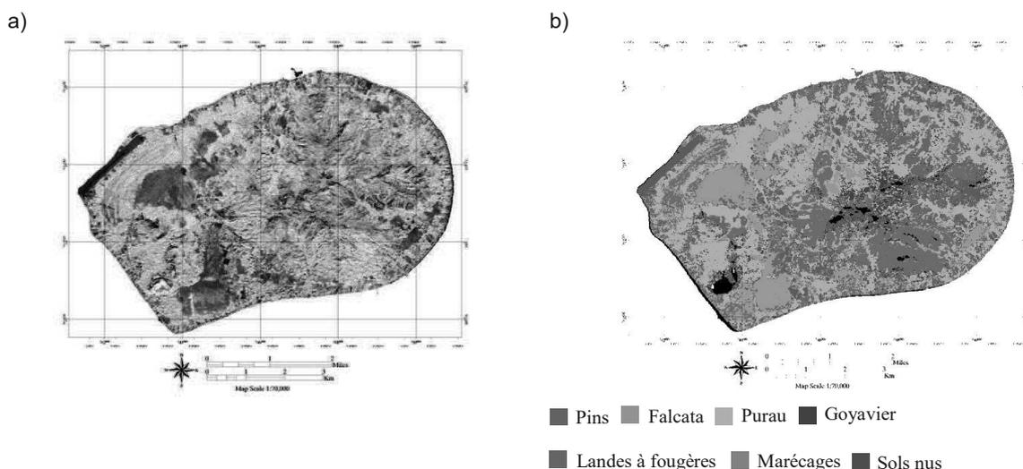
**Figure 7 :** Composition colorée représentant l'île de Tubuai (Polynésie Française) à partir d'images acquises par le capteur aéroporté AIRSAR. Rouge : bande L polarisation HH ( $|S_{HH}|^2$ ), Vert : bande P polarisation HV ( $|S_{HV}|^2$ ), Bleu : bande C polarisation VV ( $|S_{VV}|^2$ ). b) Classification de l'île de Tubuai obtenue en combinant les 3 bandes de fréquence (Lardeux *et al.*, 2009).
