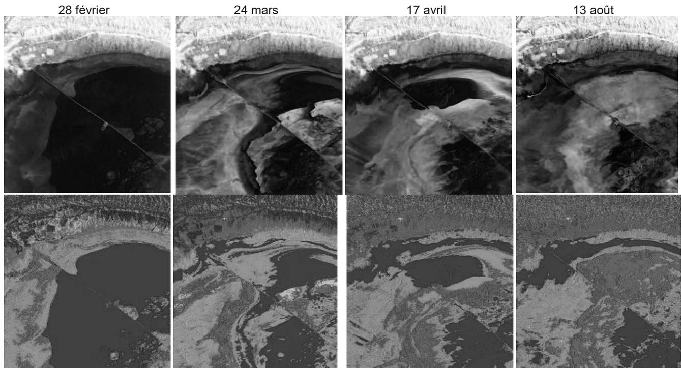
**Figure 6 :** haut : séquence temporelle d'images pleinement polarimétriques acquises par le RSO à bord du satellite RADARSAT-2 représentées selon la décomposition de Pauli ( $R : |S_{HH} - S_{VV}|^2$ ;  $V : |S_{HV}|^2$ ;  $B : |S_{HH} + S_{VV}|^2$ ); bas : classification automatique basée sur la distance de Wishart et la décomposition H/A/ $\alpha$  (Frison *et al.*, 2013).
