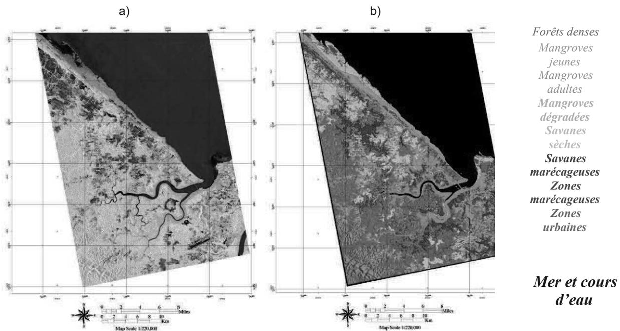
**Figure 5 :** a) Composition colorée (R :  $|S_{HH}|^2$ , V :  $|S_{HC}|^2$  ; B :  $|S_{VV}|^2$ ) d'une acquisition PALSAR sur les environs de Cayenne, en Guyane. Les zones urbaines apparaissent en teintes roses (par exemple, Cayenne sur la droite), les zones de forêt en vert, et les sols nus ou parcelles de végétation peu dense en bleu. b) Classification obtenue à partir de multiples indices polarimétriques.
