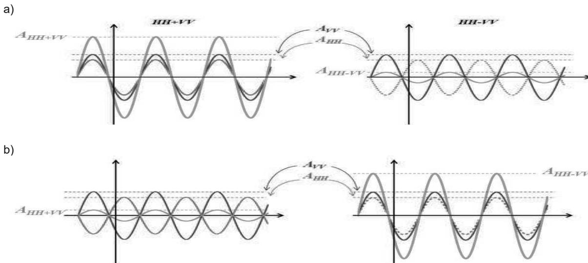
**Figure 3** : Somme et soustraction de 2 ondes a) en phase, telles que les réponses en polarisation HH et VV pour une diffusion de surface (sols nus) ; b) en opposition de phase, telles que les réponses en polarisation HH et VV observées lors d'une diffusion double (zone urbaine ou végétation inondée).
