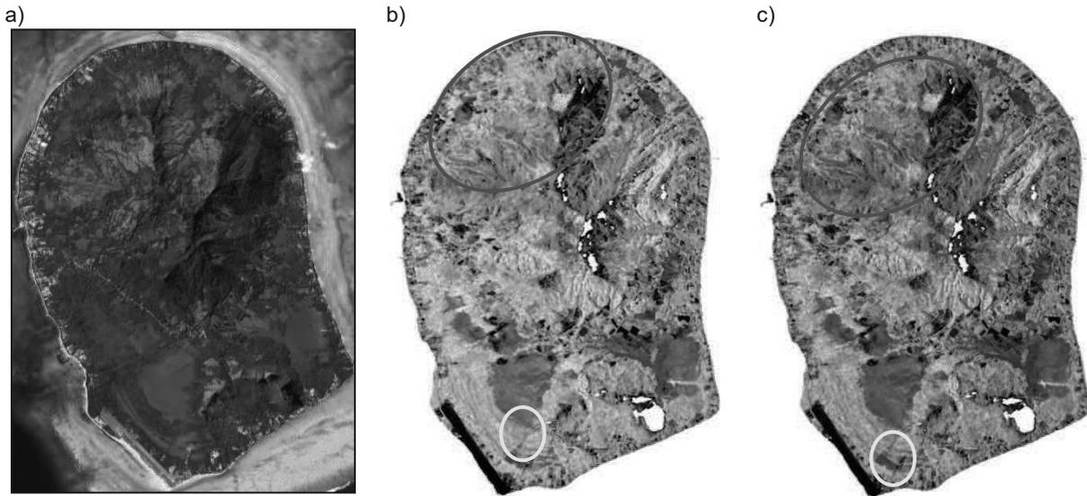
**Figure 4 :** Île du Tubuai. a) image optique (© Googleearth). Composition colorée d'une acquisition radar polarimétrique en bande L ; b)  $|S_{HH}|^2$ ,  $|S_{HV}|^2$ ,  $|S_{VV}|^2$ ; c) représentation de Pauli :  $|S_{HH} - S_{VV}|^2$ ,  $|S_{HV}|^2$ ,  $|S_{HH} + S_{VV}|^2$  respectivement pour les canaux R, V, et B.
