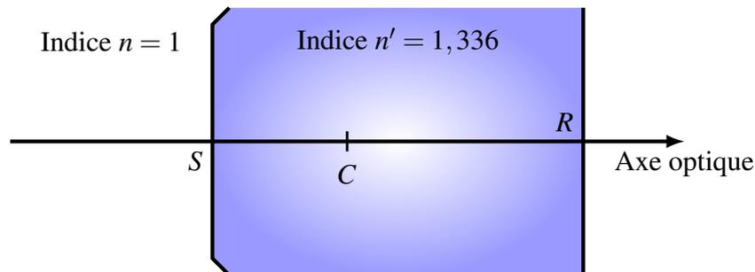
**Figure 1** – Approximation en dioptré sphérique de l'œil. L'extérieur a un indice optique  $n$  et l'œil a un indice optique de  $n' = 1,336$ . La rétine se trouve en  $R$  tel que  $\overline{SR} = 22,3$  mm, et le rayon de courbure du modèle de l'œil est de  $\overline{SC} = 5,6$  mm.
