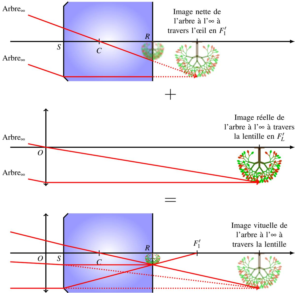
**Figure 5** – Schéma explicatif de la correction d’une hypermétropie (les échelles ne sont pas respectées, mais sont conservées d’une image à l’autre) : (i) objet de l’infini vu flou par un œil hypermétrope. (ii) image réelle créée à partir d’un objet situé à l’infini à travers une lentille convergente (le plan focal objet  $F$  n’est pas représenté). (iii) correction de l’hypermétropie, permettant de voir un objet à l’infini.
