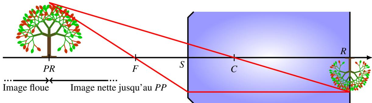
**Figure 3** – Au repos/sans accommodation, un objet placé au punctum remotum ( $PR$ ) se formera sur la rétine d'une personne myope : l'image sera nette. Pour la construction : le rayon passant par  $F$  ressort parallèlement à l'axe optique, et le rayon passant par  $C$  est non dévié.
