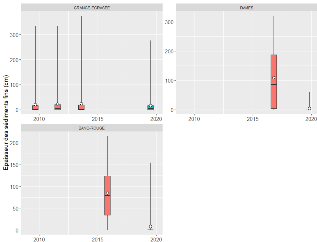
Figure 7 - Evolution des épaisseurs sédimentaires mesurées avant (en rouge) et après travaux (en bleu, 2019) dans les lônes de la Grange écrasée, des Dames et du Banc-Rouge. Les boîtes à moustaches représentent la distribution des valeurs mesurées lors des différentes campagnes. Les extrémités de chaque « boîte » représentent les 25 ème et 75 ème percentiles. Les traits noirs horizontaux représentent les valeurs médianes et les points blancs la moyenne. Les « moustaches » (lignes verticales) représentent les valeurs minimales et maximales observées.
