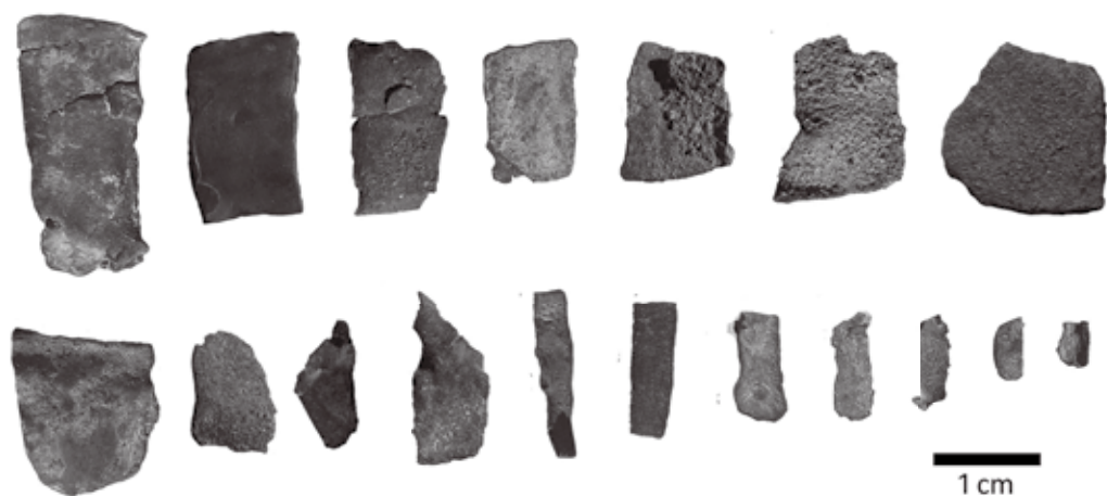
Figura 8. Recortes laminares de cobre posiblemente sin alear del sitio 02-Qui-89.
