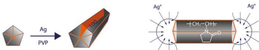
Figure 2 : Action du PVP sur un germe d'argent
