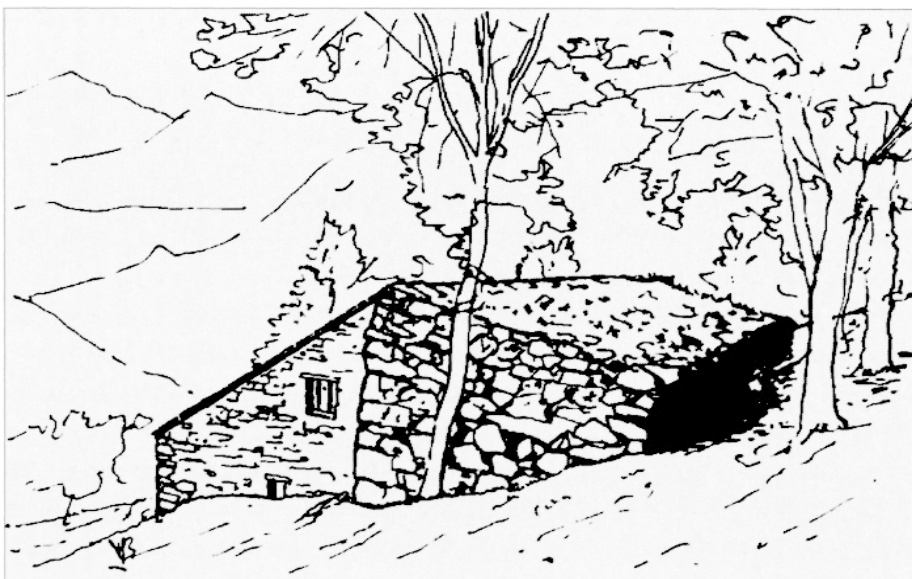
Figure 6 : Protection pour les granges exposées aux avalanches d'hiver et de printemps.
