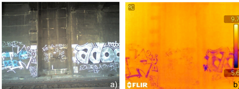
Figure 15 : Influence des variations d'albédo sur le champ de température d'un mur a) image visible du mur et b) image thermique de la même zone. Les zones plus claires (albédo élevé) sur l'image visible correspondent aux zones plus froides sur l'image thermique, car réfléchissant plus le rayonnement incident. Noter les hétérogénéités de température entre les zones peintes de façon uniformes et les zones où la peinture a disparu (courtoisie du Cerema /RFF).
