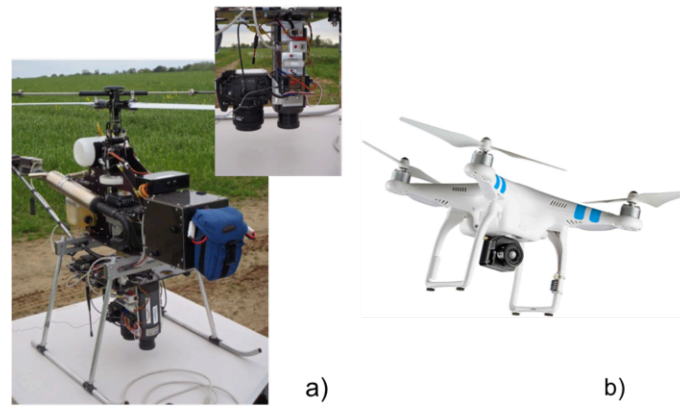
Figure 10 : Drone Copter 1B (©EADS-Surveycopter) possédant une caméra thermique ainsi qu'un appareil photo de type reflex (IFSTTAR/Cerema); b) Drone ©Phantom 2 de la société DJI équipé d'une caméra thermique ©FLIR Vue.
