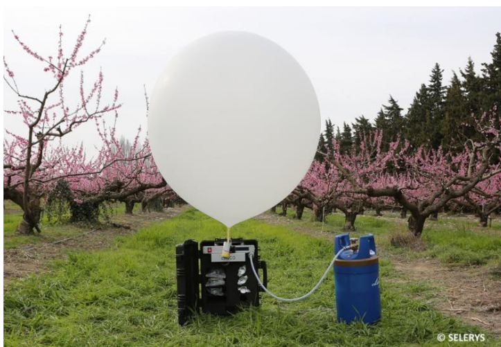
Système de tir d'un ballon sonde équipé – © SELERYS
