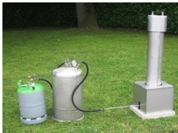
Générateur à iodure d'argent – © Anelfa
