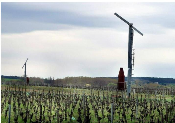
Tour anti-gel fixe en vigne avec système de chauffage
