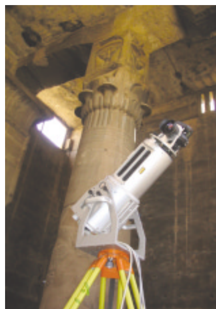
Fig. 2 : Le scanner 3D Riegl LMS Z 420i.
