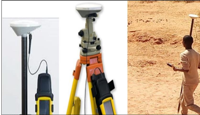
Figure 4 : L'appareil DGPS Trimble R<sup>3</sup> utilisé pour les levées XYZ
