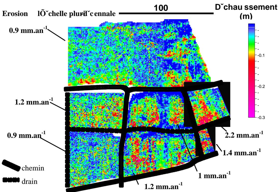
Figure 9. Exemple de carte de mesures du déchaussement des ceps, chaque cep est représenté par un pixel ( $1 \text{ m}^2$ ). Les vitesses d'érosion des différentes parcelles (en  $\text{mm}/\text{an}$ ) sont calculées une fois l'âge des vignes connu (Butte de Corton)
