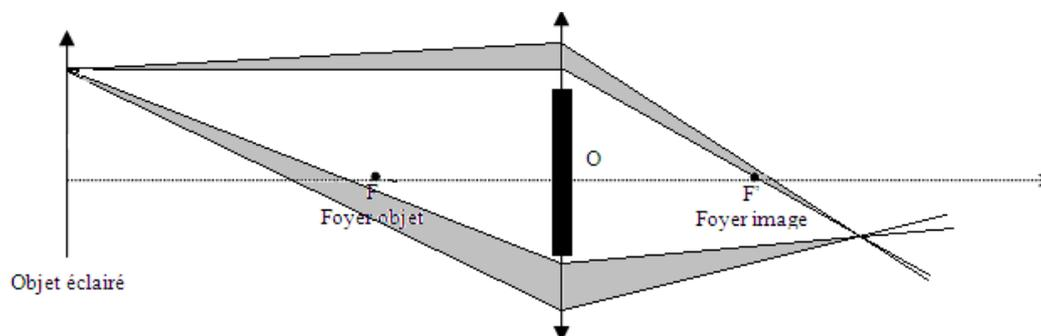
Fig. 7: Correspondance point-objet / point-image par l'intermédiaire de faisceaux non «standards»
