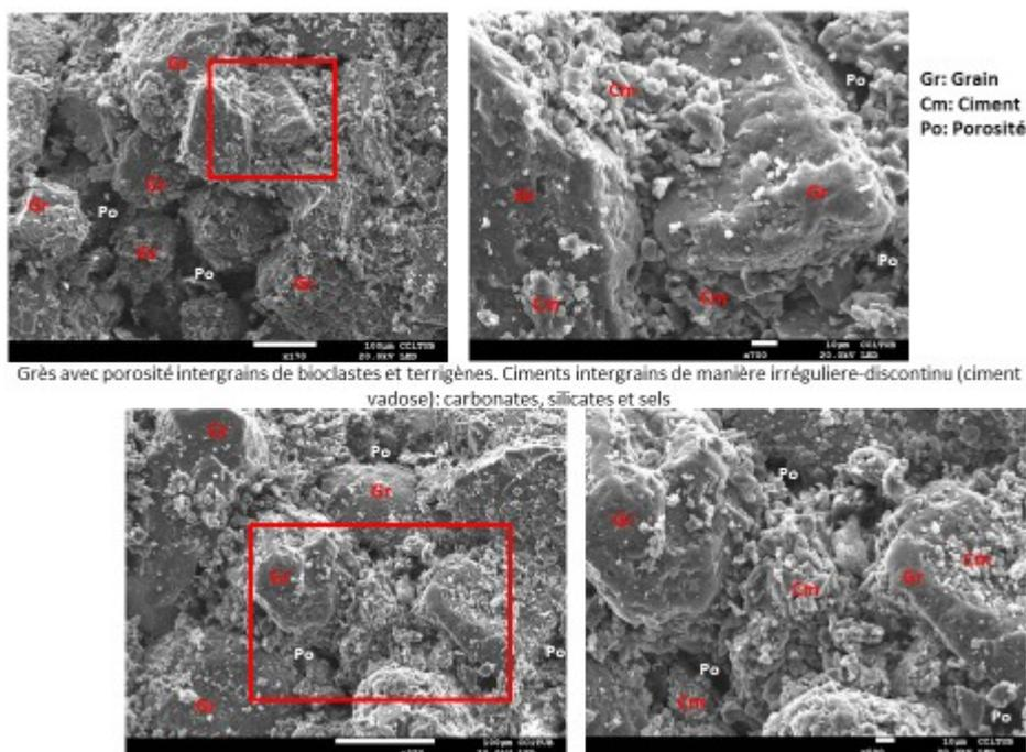
Figure 7 : Boughrara, microphotographies de l'échantillon **06 TIZ 17** (U2, SD3) : éolianite à ciment de calcite et de calcite magnésienne, zéolite, halite et gypse en quantités mineures.
