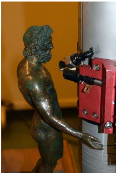
FIGURE 2 – Imagerie XRF d'un bronze romain à l'aide d'un instrument MA-XRF portable développé au C2RMF. Bronze représentant Jupiter, site archéologique de Bavay, Nord-Pas-de-Calais. © T. Calligaro, C2RMF
