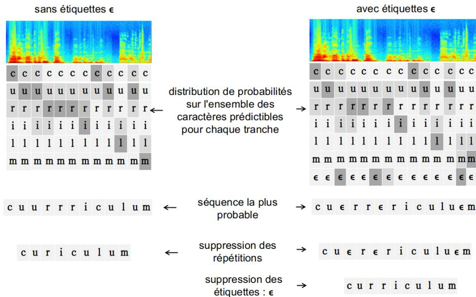
FIGURE 2 – exemple d’alignements de la fonction CTC
