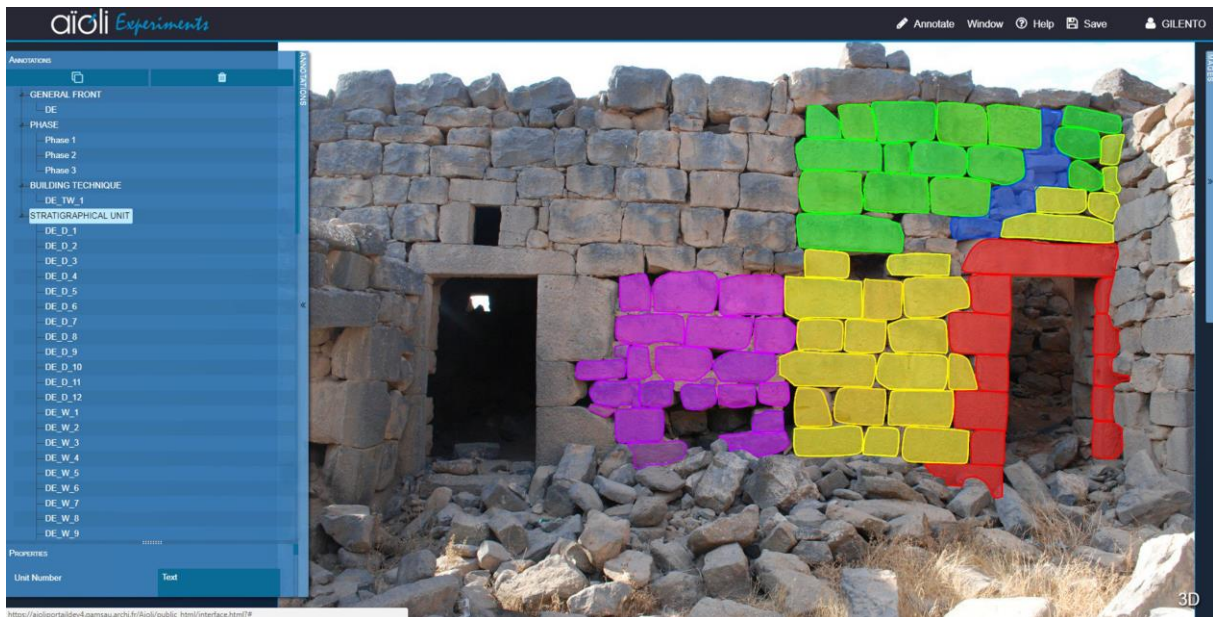
Fig 3. Analyse stratigraphique d'un bâtiment à Umm as-Surab, au nord de la Jordanie (Piero Gilento, ACTECH)
