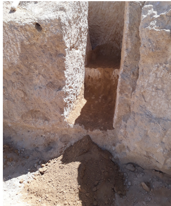
Fig. 15. Aspect des résidus générés par la taille sur pierre humide.
