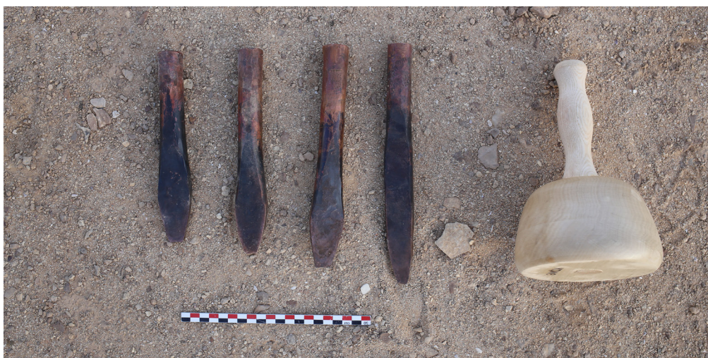
Fig. 11. Maillet en hêtre et ciseaux en cuivre modernes utilisés lors de la première campagne.
