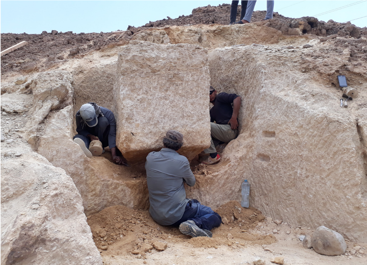
Fig. 18. Taille en sape d'une tranchée périphérique à la base du bloc avant son détachement par fracturation.
