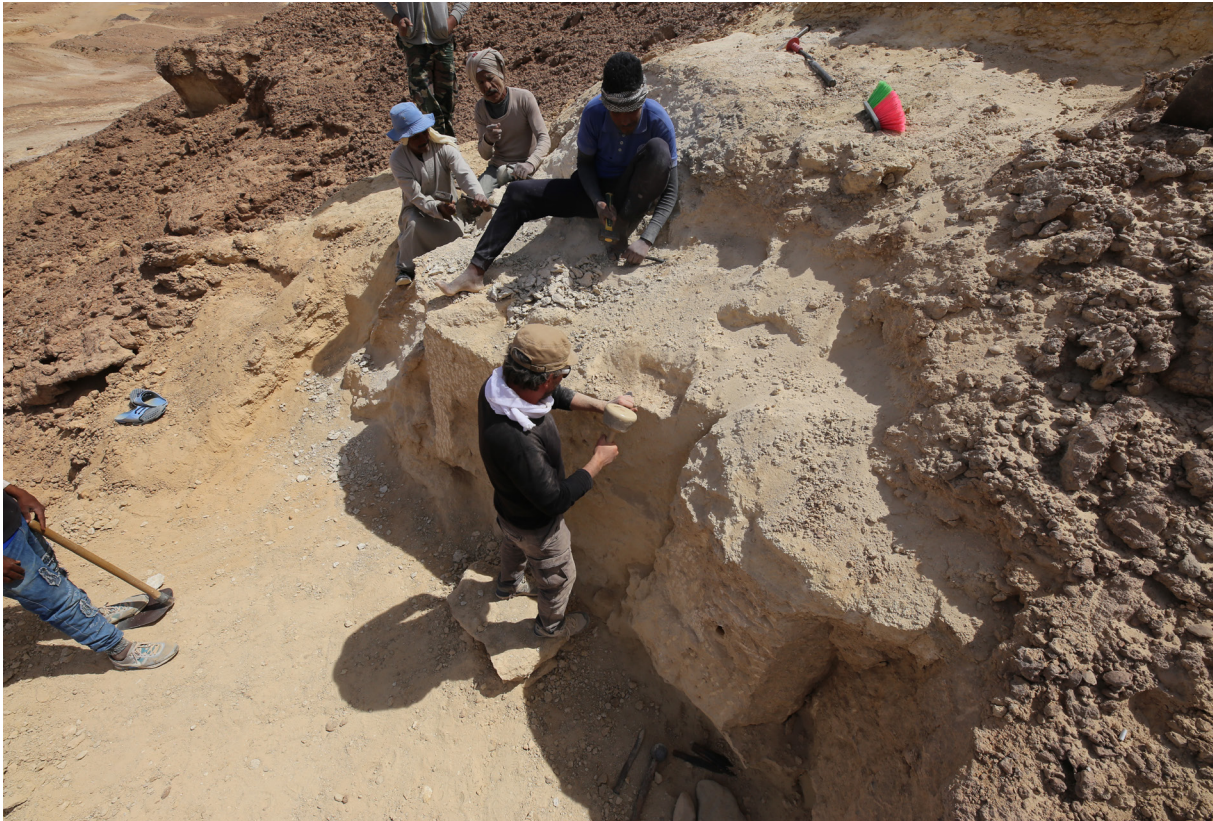
Fig. 12. Les premiers coups de ciseaux dans la zone d'extraction moderne : préparation du front de taille et du lit supérieur.
