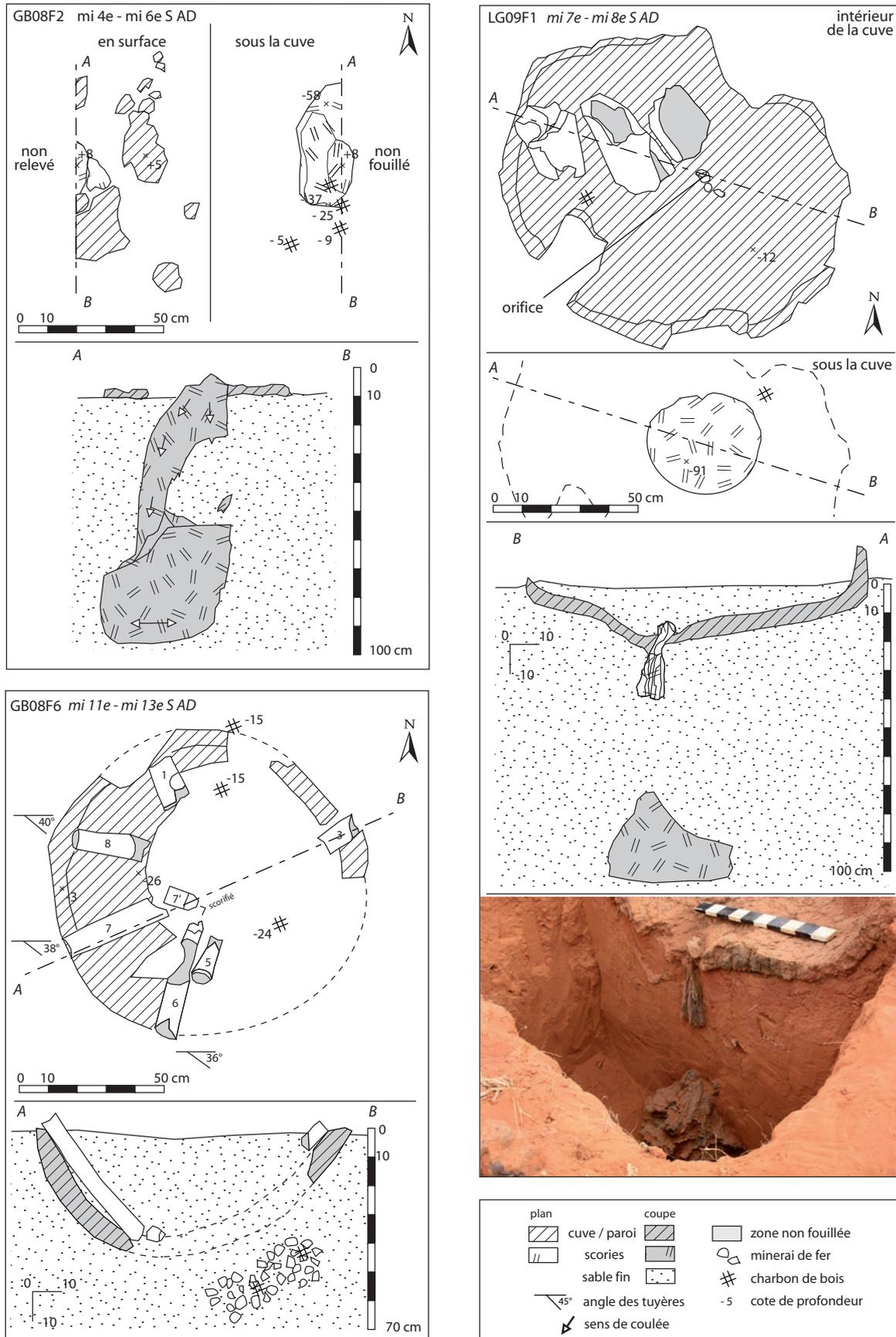
**Figure 9.** Plan et coupe de bas fourneaux à scorie coulée à écoulement vertical (SC-v) GB08F2, LG09F1 et GB08F6. Photographie de LG09F1 en cours de fouille montrant la coulure de la scorie à travers la cuve au dessus d'un bloc massif de scorie.
