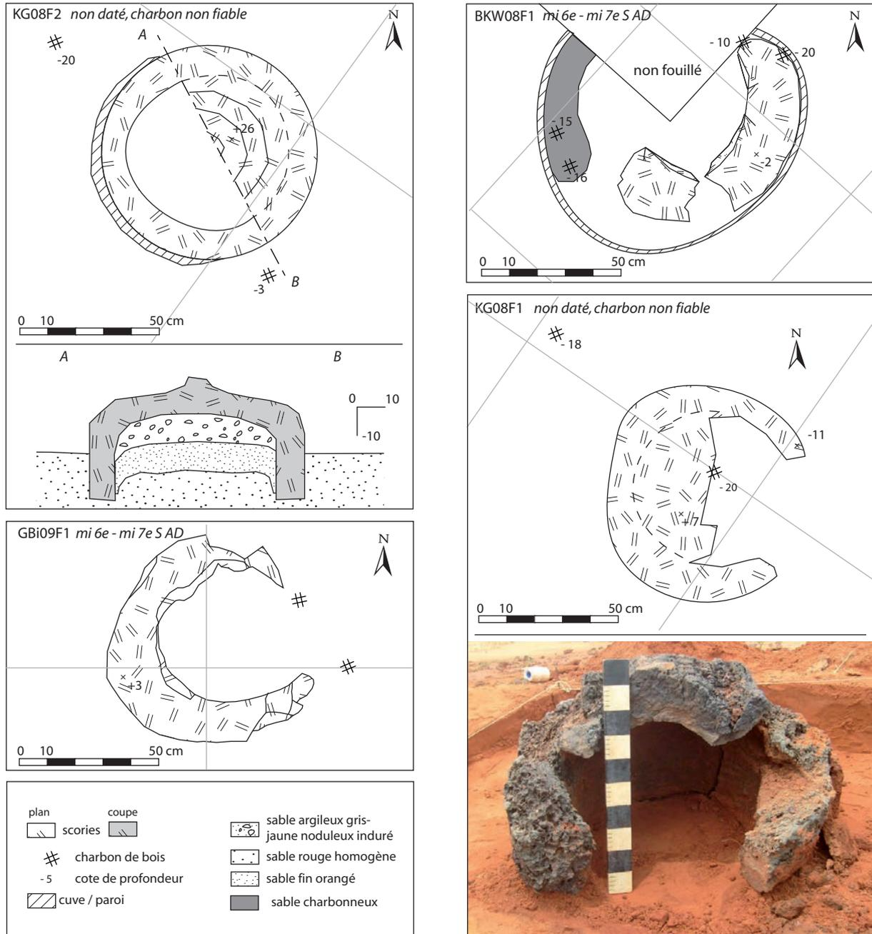
**Figure 6.** Plan et coupe des bas fourneaux à scorie piégée en anneau (SPa) BKW08F1, KG08F1, KG08F2 et GBi09F1.
