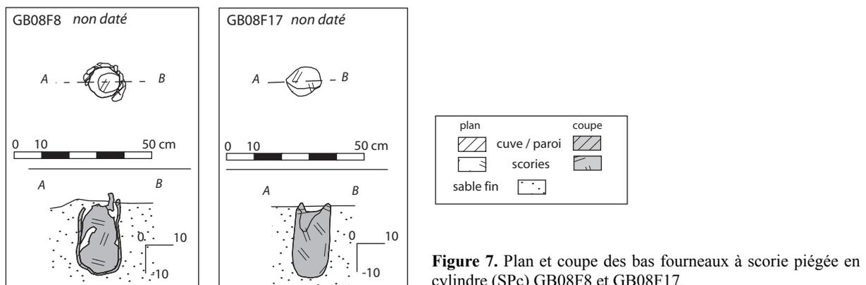
**Figure 7.** Plan et coupe des bas fourneaux à scorie piégée en cylindre (SPc) GB08F8 et GB08F17.
