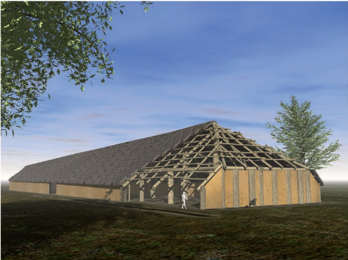
Fig. 35 - Reconstitution du bâtiment monumental avec un pignon en croupe (n° 1) et un pignon en croupe et des murs en torchis (n° 2) selon les calculs de R. PALAU et la reconstitution 3D de S. THOUVENOT.
