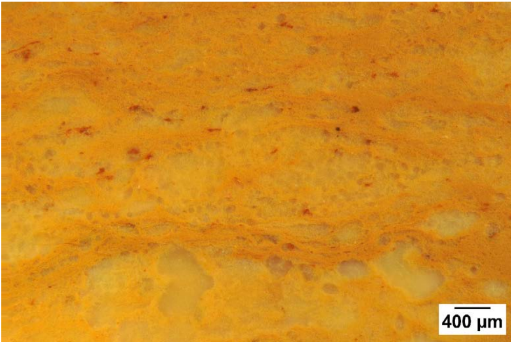
Figure 35.5: Loupe quartzeuse recristallisée et reliques de quartz.
