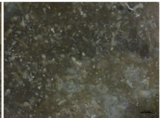
Photo 2 : Texture bioclastique et porosité intercrystalline
