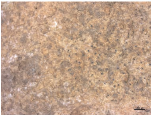
Photo 1 : Néo-cortex de conglomérat à émoussé moyen, cimentation forte et golfes de dissolution
