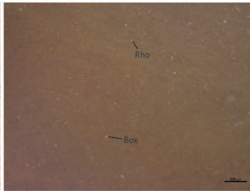
Photo 2 : Texture wackestone, rhomboédres et boxworks
