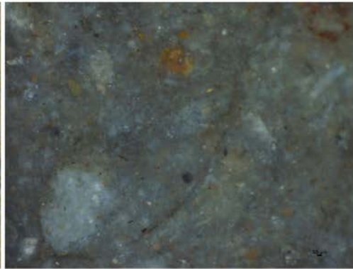
Photo 2 : Texture wackestone et débris bioclastiques indéterminés
