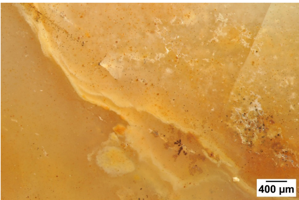
Figure 35.13 : Membrane partiellement détruite, plissée et fragmentée.
