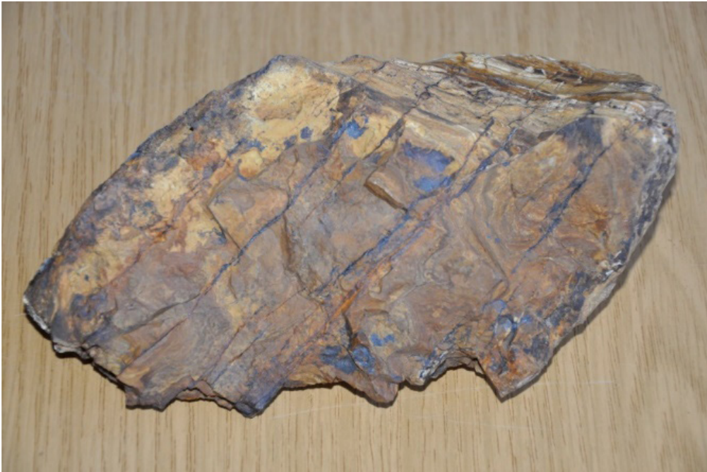
Figure 35.8 : Fentes siliceuses enduites de dépôts ferromanganésifères tardifs.
