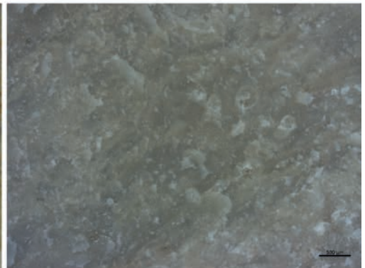
Photo 2 : Porosité intercrystalline et intraclastique
