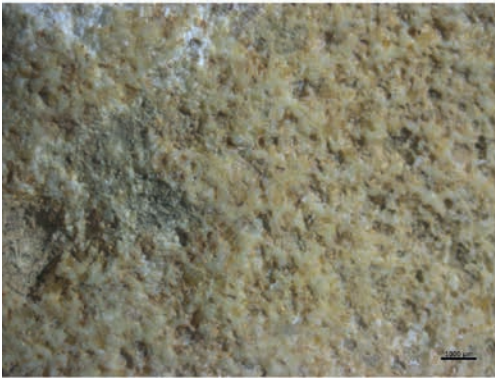
Photo 1 : Néo-cortex alluvial à émoussé et cimentation forts et golfes de dissolution
