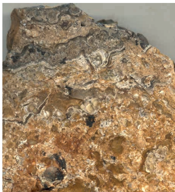
Figure 34.2 : Hill Top - Echelle : 14,48 x 15,76 cm. Niveau construit à structure contournée (épaisseur ~ 1,5 cm) surmontant un dépôt bréchique à éléments concrétionnés parfois légèrement fragmentés et d'origine stromatolitique. Certains éléments subsphériques sont zonés (échantillon prélevé à 3 m au sud du sondage).
