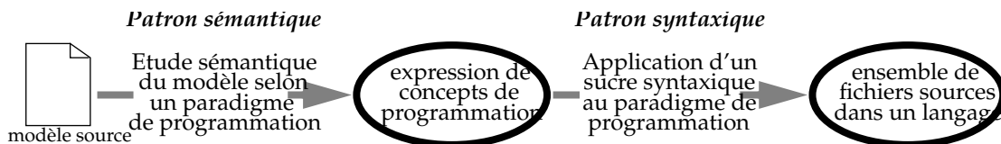
Figure 1 : Utilisation de MetaScribe pour la construction d'un générateur de programmes.
