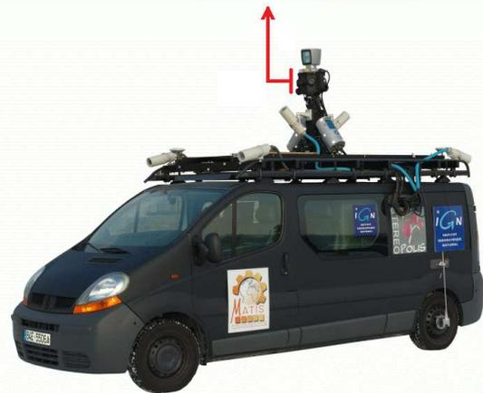
Figure 1. Véhicule STEREOPOLIS et configuration de sa tête panoramique
