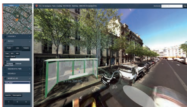
Figure 8 : Simulation d'aménagement du mobilier urbain (le positionnement et l'échelle du modèle sont modifiables lors de la simulation).
