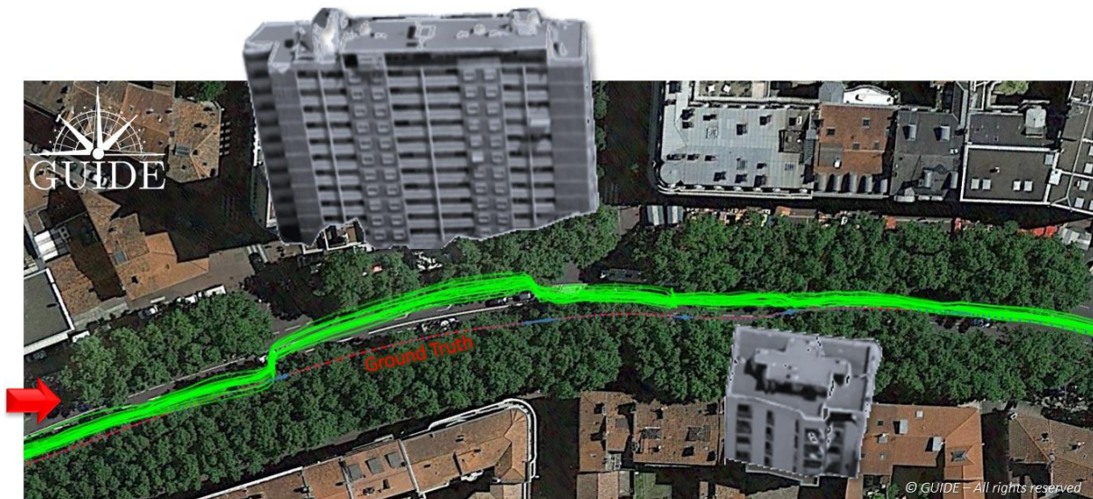
Figure 4 - Effet de la propagation des signaux GNSS sur des récepteurs à proximité d'un immeuble
