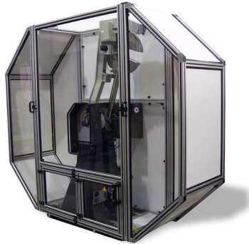
Photo 1 : Mouton de Charpy 750 joules, dispositif utilisé pour la mesure de la résilience des aciers (tiré du cours Produits Procédés et Matériaux de X. Pessoles 2013)
