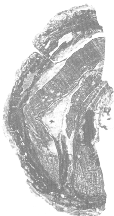
PL. 10 : Reconstitution de l'enroulement de la douille après une analyse micro-graphique qui a particulièrement mis en évidence l'emploi de 2 feuilles :
