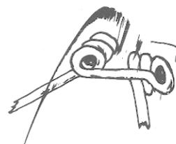
Pour ces différentes phases, les contraintes thermiques ont été très élevées et répétées. Les contraintes mécaniques sont moindres, mais la torsion importante du fil implique une micro-fissuration malgré le chauffage au rouge.
