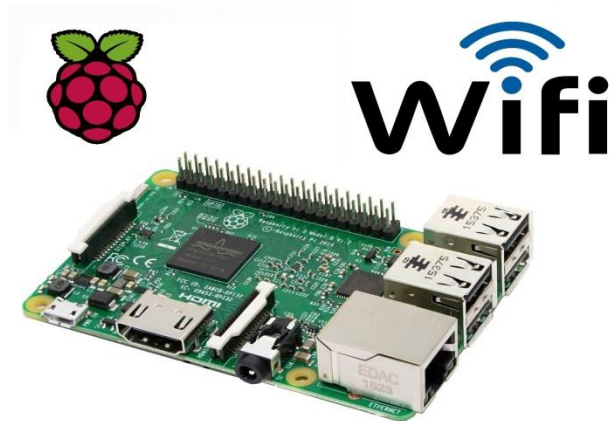
Figure 20 : Raspberry Pi en routeur WiFi. (Source : Dadarevue, 2017 36 )
